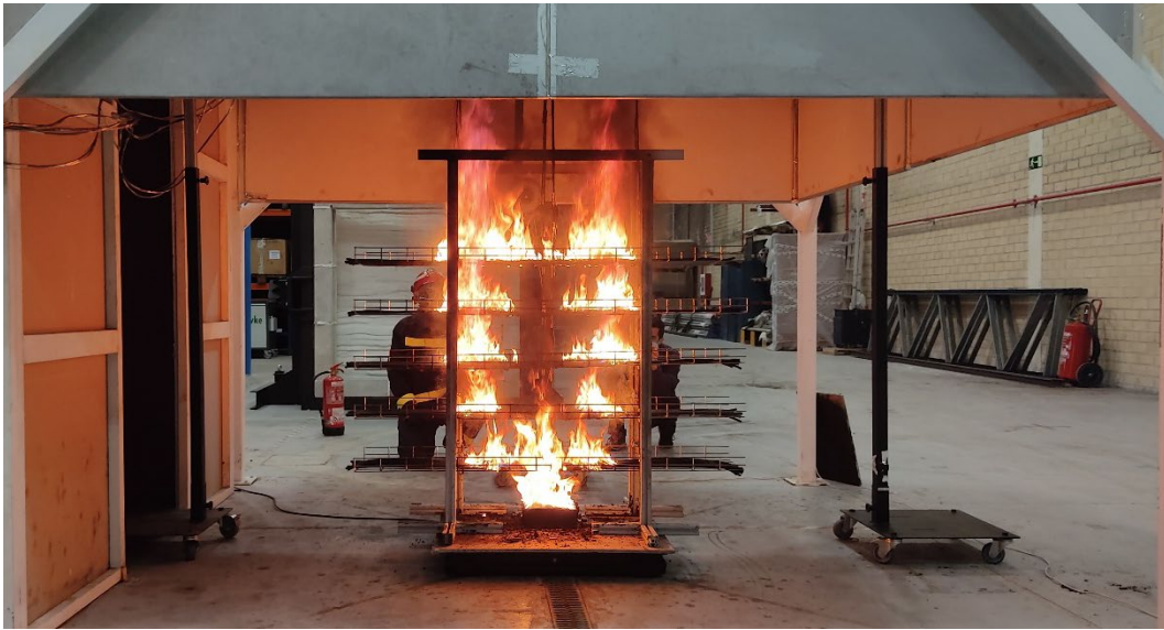
Ensayo de propagación del fuego a escala real en 5 bandejas de cables realizado en el Proyecto "Metodologías avanzadas de análisis y simulación de escenarios de incendios en centrales nucleares" dentro del acuerdo suscrito por el CSN con la Universidad de Cantabria.
